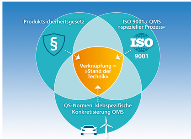
Bild 2: Stand der Technik: Produktsicherheitsgesetz + QMS (ISO 9001) + QS-Klebnormen (Bild Fraunhofer IFAM I Bremen)
